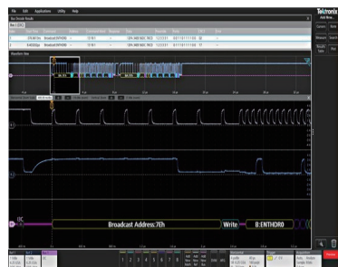
图三 系统支持DPHY的I²C和DSI-1、CSI-2总线解码和搜索
