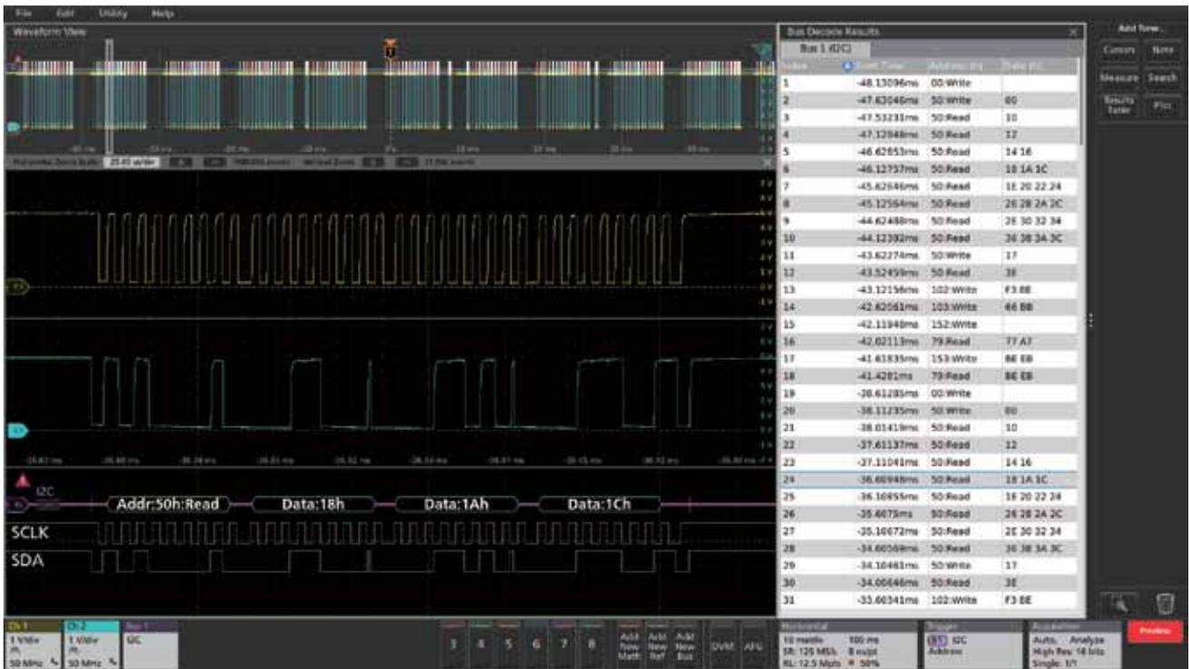
时间相关的波形的总线解码显示是许多硬件工程师熟悉而又实用的格式。而对固件工程师来说，结构表格式可能会更加实用。这种带时间标记的总线活动显示画面可以简便地与软件列表进行对比，简便地计算执行速度。
