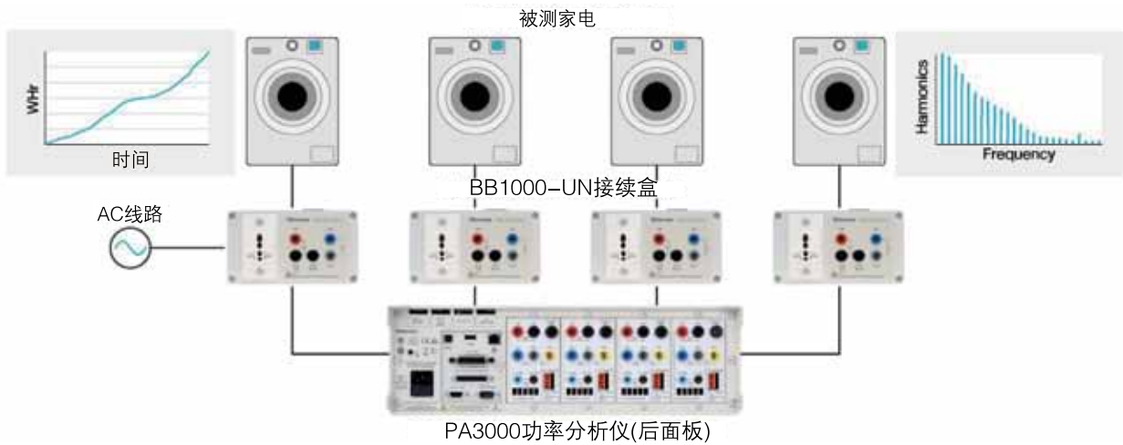
家测试电和消费电子的测试配置和测量结果实例
