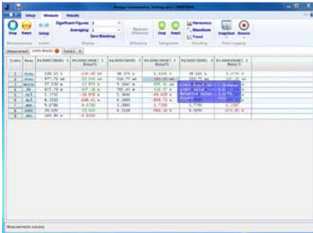
在所有测量的参数上进行个性化极限检查，自定义设置极限
